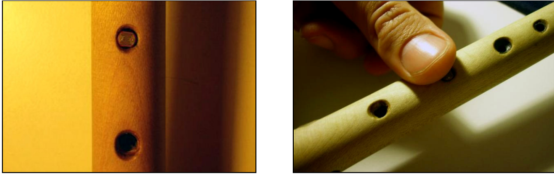
Fig. 4-2. Esempio di integrazione di una fotocellula all'interno di una canna sonora.
