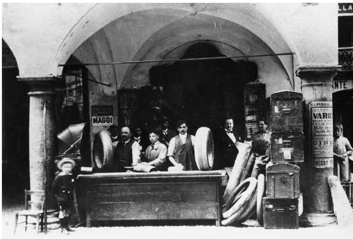
Fig. 74. Lugano, 1915 circa: l'«Antica Selleria Eugenio Morandi». Sulla destra troneggiano alcuni bauli che attendono di essere riparati; si notano inoltre svariati copertoni in cuoio, ideati negli anni della prima guerra mondiale dalla ditta Morandi per far fronte alla scarsità di pneumatici per autocarri (da FONTANA, Selee 183).
