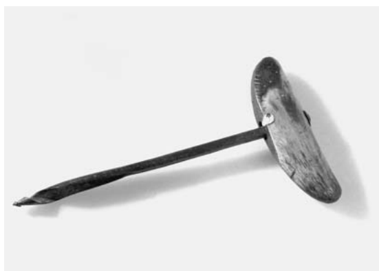
Fig. 85. Corno utilizzato come impugnatura di un succhiello (Museo di Val Verzasca, Sonogno; fot. R. Pellegrini).
